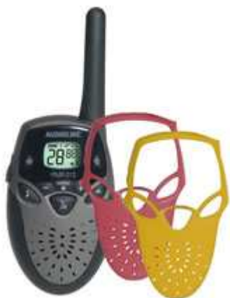
Austauschbare farbige Frontschalen zur besseren Unterscheidung der Funkgeräte
